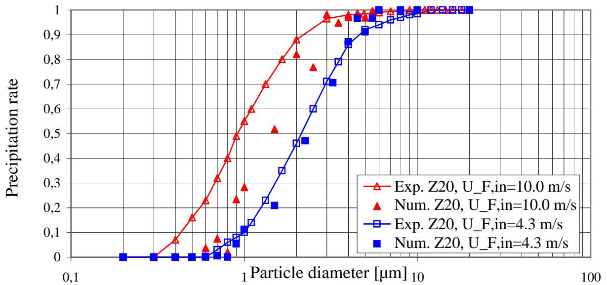
Vergleich der Trenngrade für Z20 bei  $u_{F,\text{in}} = 4.3 \text{ m/s}$  und  $u_{F,\text{in}} = 10 \text{ m/s}$
